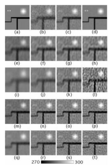
Fig. 2. Simulation images. Images cover an area  $6^{\circ} \times 6^{\circ}$  in longitude and latitude at 32 pixels/deg. (a) Synthetic test image, (b) nonenhanced 19 V, (c) nonenhanced 37 V, (d) nonenhanced 85 V, (e) SIR 19 V, k=10, (f) SIR 19 V, k=20, (g) SIR 19 V, k=25, (h) SIR 19 V, k=40, (i) BGI 19 V,  $\gamma=\pi/2$ , (j) BGI 19 V,  $\gamma=7/5$ , (k) BGI 19 V,  $\gamma=1$ , (l) BGI 19 V,  $\gamma=0$ , (m) SIR 37 V,  $\gamma=1$ , (n) BGI 37 V,  $\gamma=1$ , and (t) BGI 37 V,  $\gamma=0$ .
